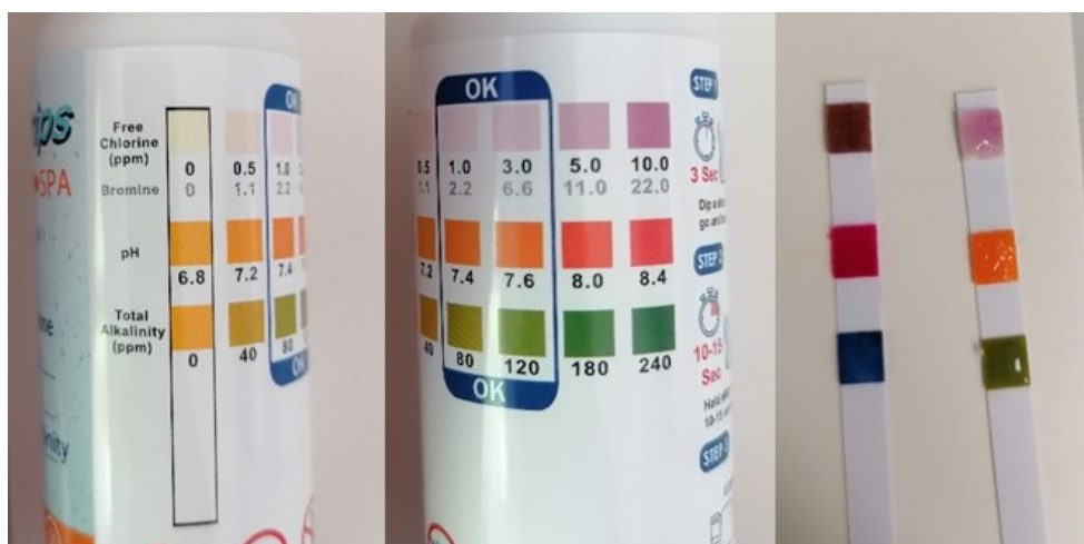
Slika 6. Test trakice za određivanje razine slobodnog klora (slika iz osobne arhive)
