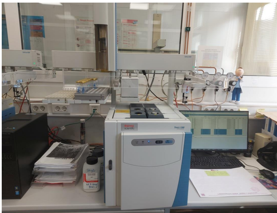
Slika 9. GC-ECD Thermo Trace 1300 GC s ECD detektorom
