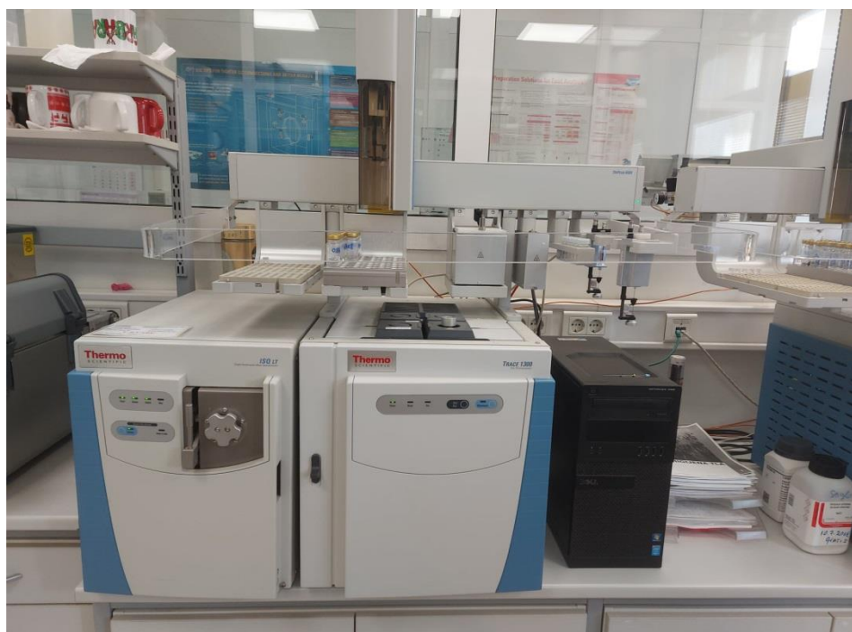
Slika 10. GC-MS Thermo Trace 1300 GC – MS spektrometar masa ISQ LT
