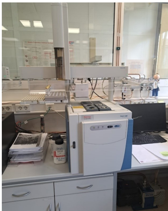
Slika 13 Plinski kromatograf Thermo Trace 1300 GC s ECD detektorom izvor:osobna kolekcija
