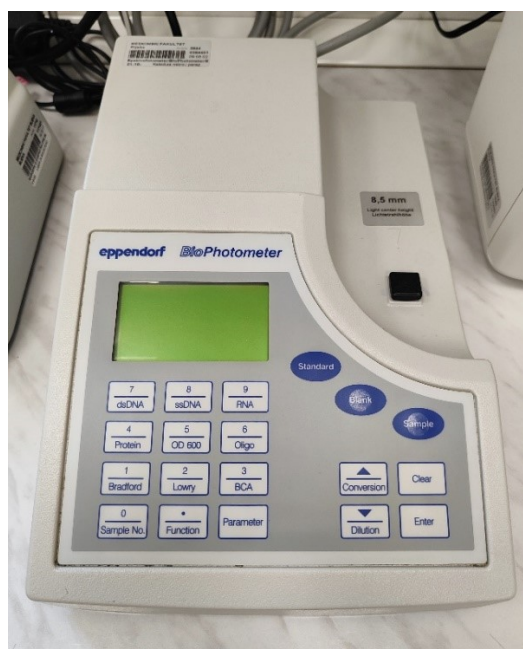
Slika 6. VIS spektrofotometar BioPhotometer 6131.
