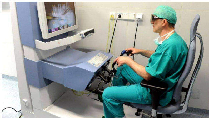
Slika 11. Kirurg KBC Zagreb smješten za konzolom Senhance robotskog sustava, (preuzeto sa https://www.kbc-zagreb.hr/415-operacija-raka-prostate-uz-pomoc-robotu.aspx )
