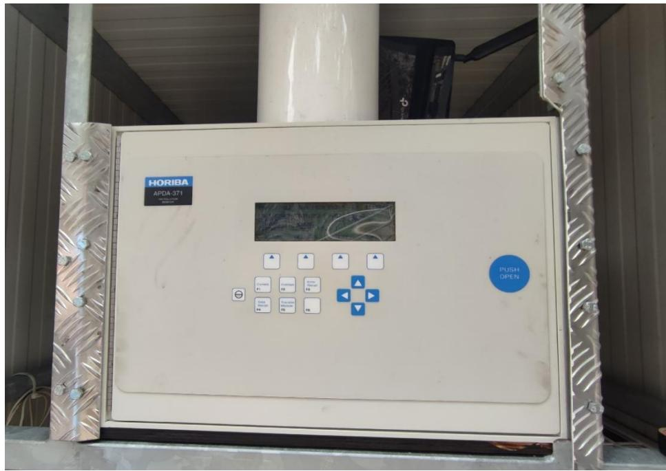
**Slika 10.** Automatski analizator Horiba APDA - 371 u kućištu
