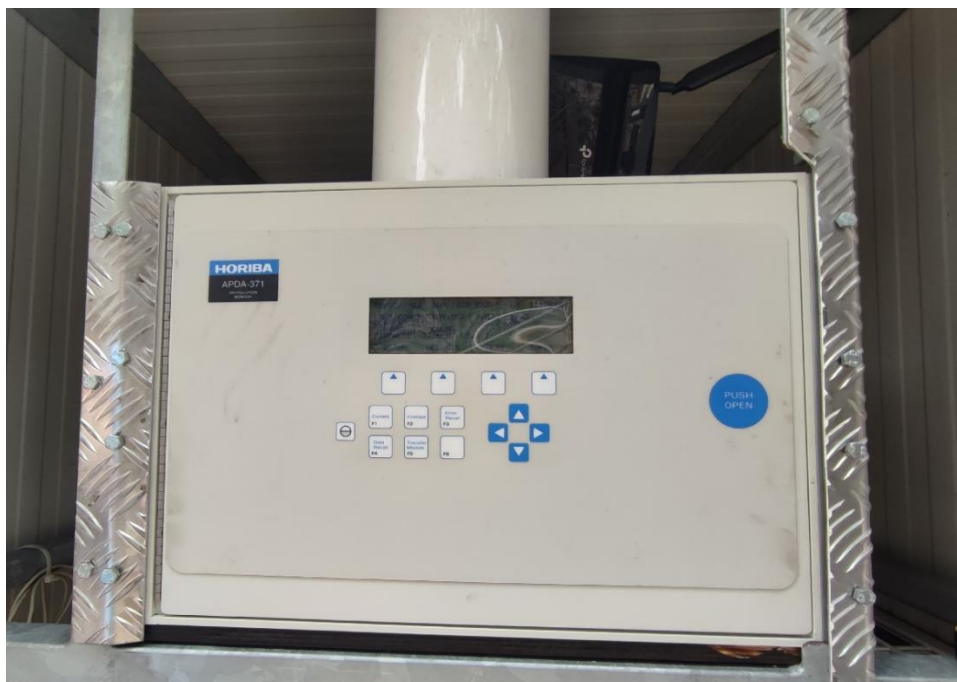
Slika 10. Automatski analizator Horiba APDA - 371 u kućištu
