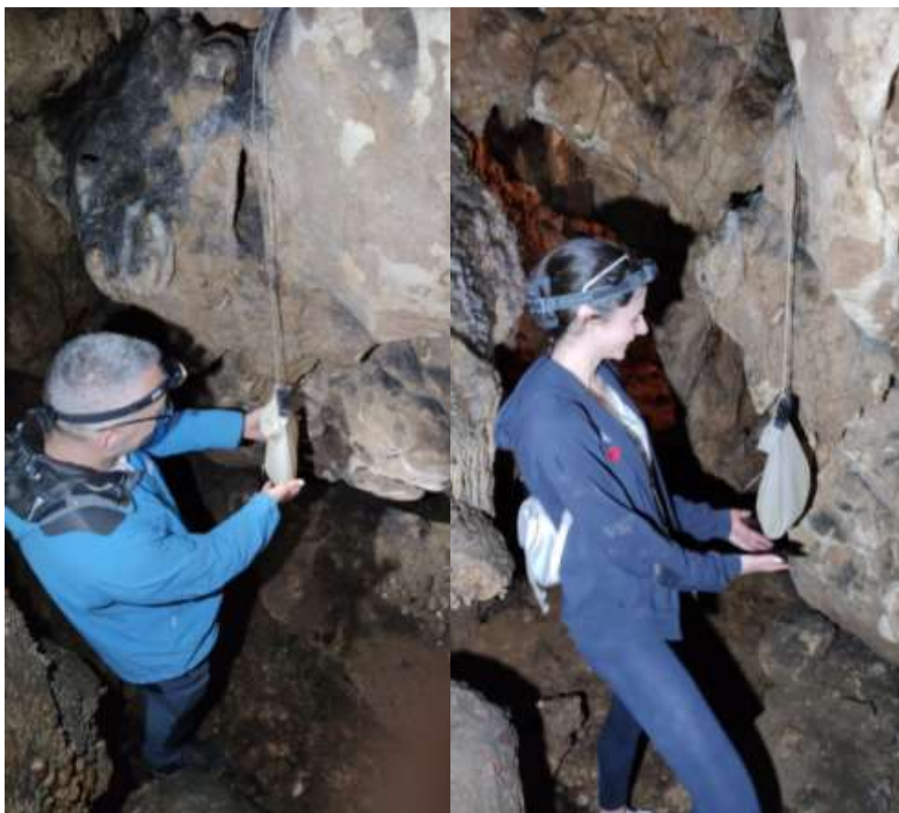
Slika 11. Postavljanje uređaja za mjerenje radona u špilji Biserujka
