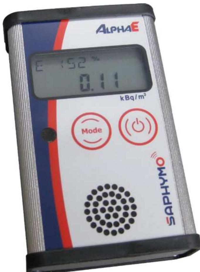
Slika 6. Prikaz AlphaE uređaja koji je korišten za mjerjenje koncentracije radona.
