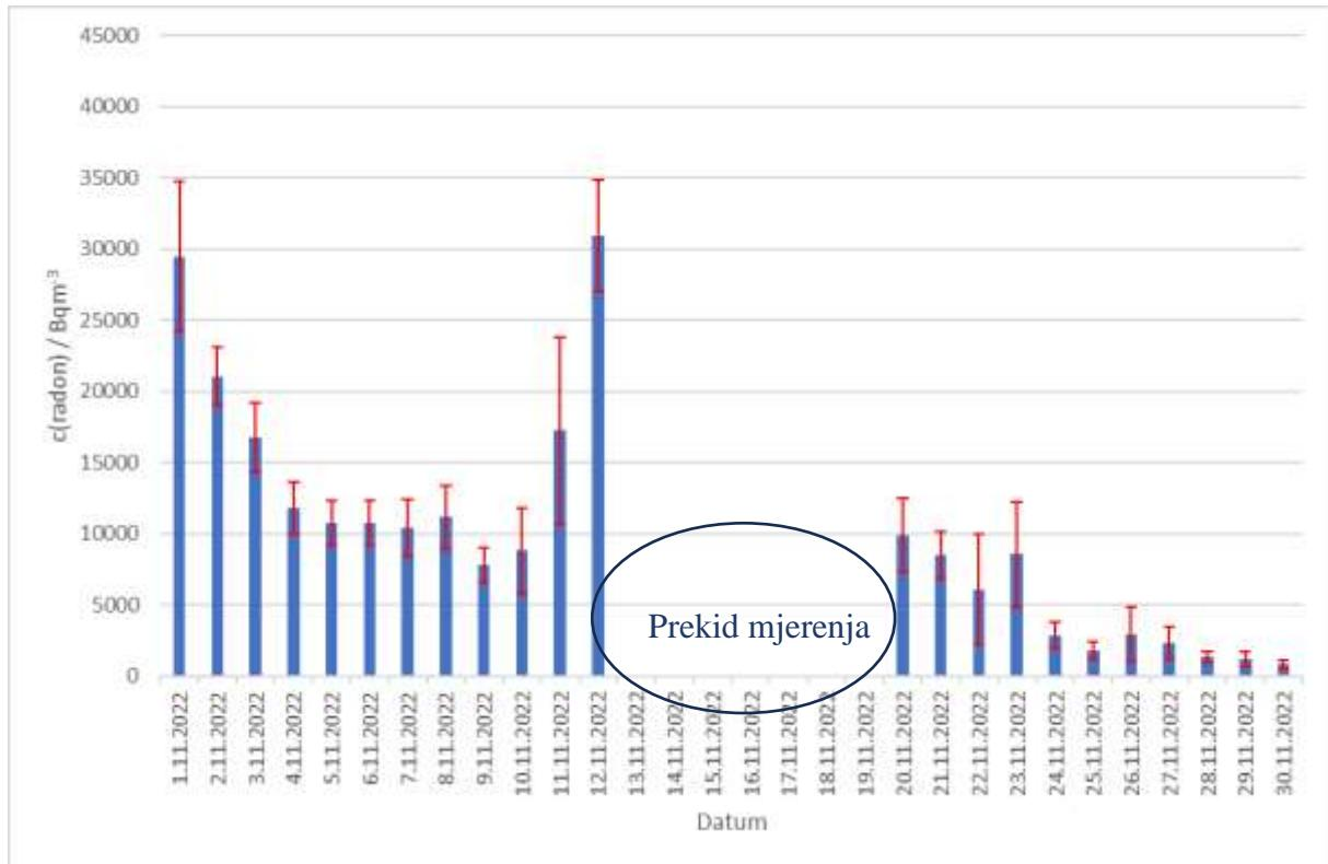
Slika 16. Koncentracije radona u Šparožnoj pećini u studenom 2022. Na slici su prikazane aritmetičke sredine sa standardnim devijacijama dnevnih koncentracija radona.
