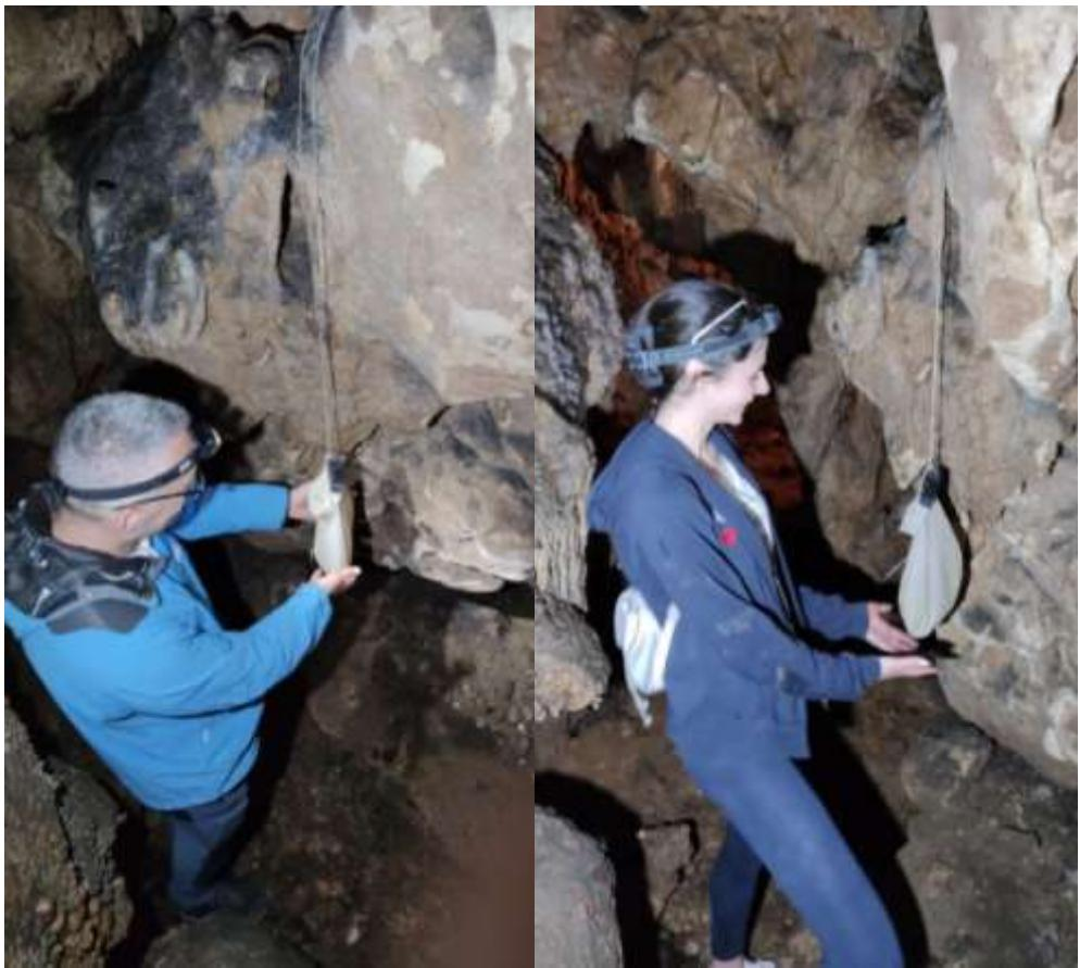
Slika 11. Postavljanje uređaja za mjerjenje radona u špilji Biserujka
