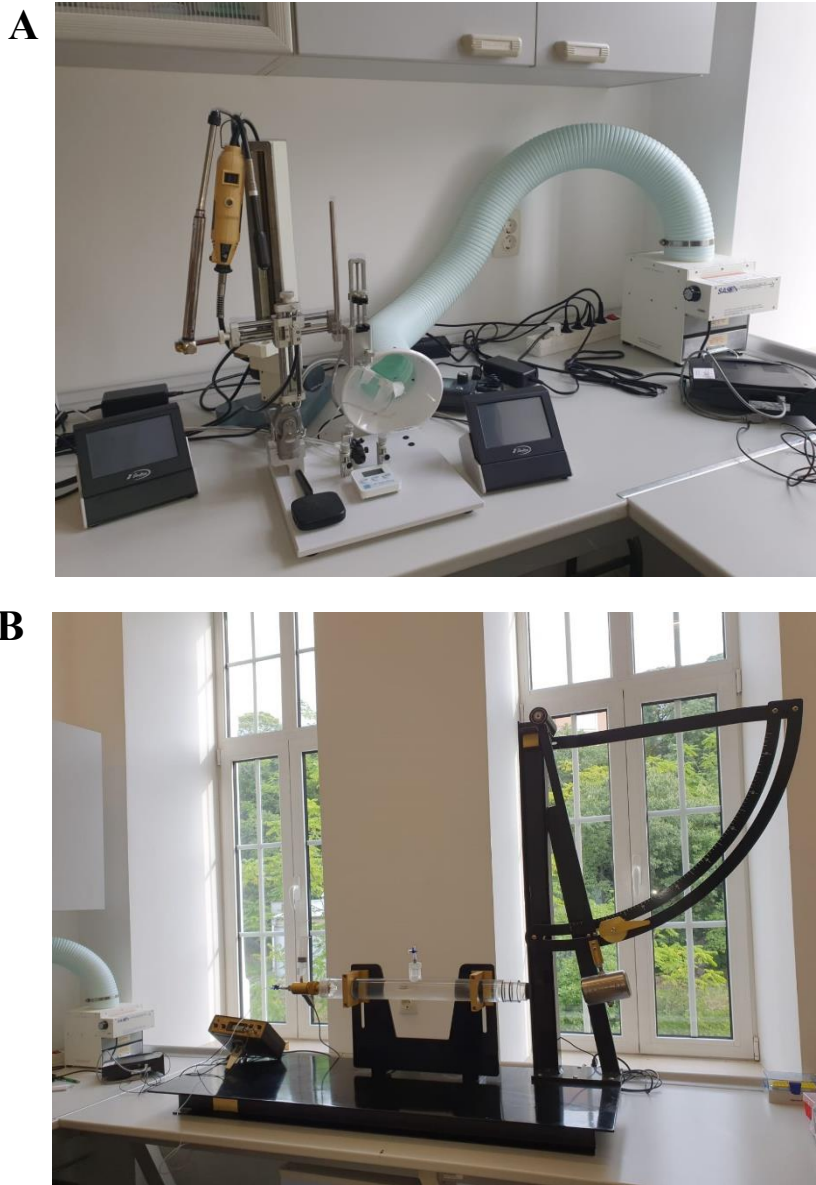
Slika 3. Sustav za eksperimentalnu traumatsku ozljedu mozga. (A) uređaj za stereotaksiju sa sustavom za inhalacijsku anesteziju i automatiziranim injektorom te bušilica; (B) aparat za lateralnu ozljedu tlakom tekućine s pretvaračem signala i osciloskopom.
