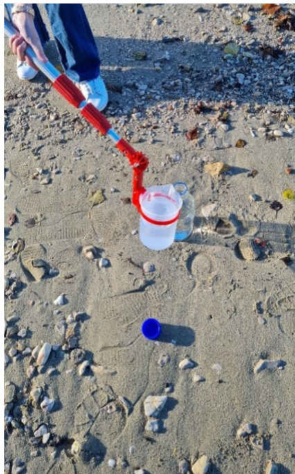
Slika 8. Prikupljanje uzoraka mora u sterilne prozirne boce (izvor: Odsjek za sanitarnu mikrobiologiju i biologiju okolišan NZZJZ PGŽ)
