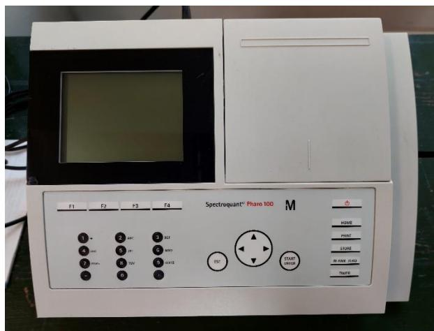
Slika 11. Spektrofotometar Spectroquant® Pharo 100
