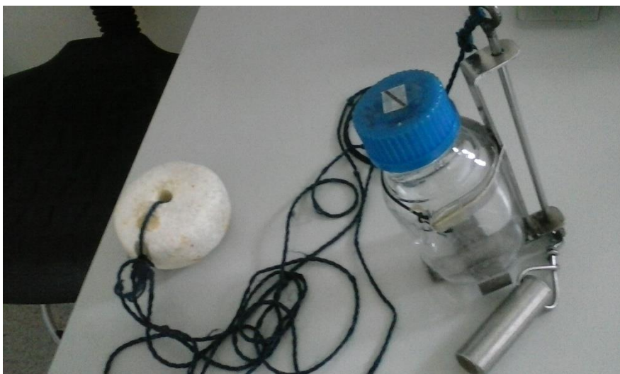
Slika 10. Ručni uzorkivač (Izvor: Odsjek za sanitarnu mikrobiologiju i biologiju okoliša NZZJZ PGŽ)
