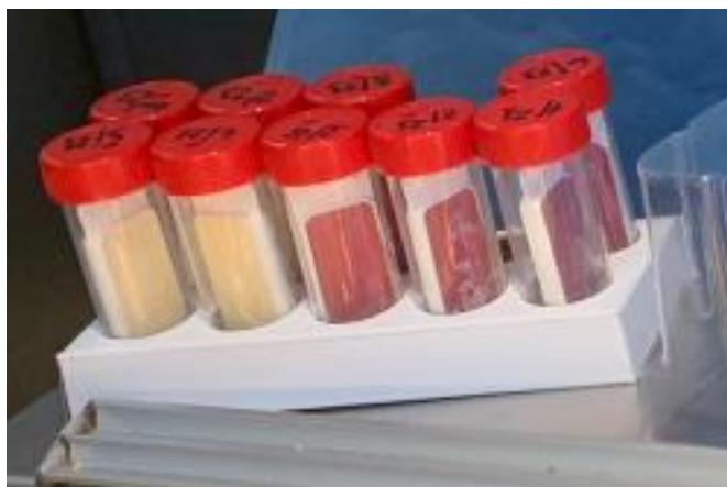
Slika 9. Agar pločice za provjeru dezinfekcije
