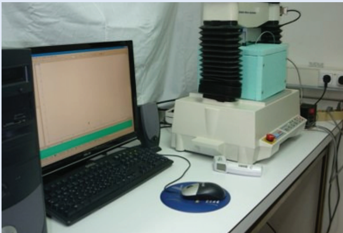
Slika 1. Kidalica Texture Analyser TA.HD.plus (Stable Micro Systems, Godalming, Velika Britanija) s priručno izrađenom termalnom komorom na ispitnom dijelu uređaja.
