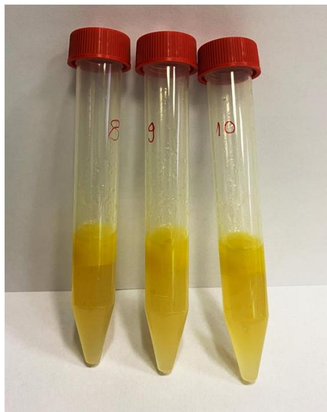
**Slika 12.** Izgled sadržaja epruveta (djekičansko maslinovo ulje i *Fast Blue BB* reagens u alkalnom pH) nakon emulgiranja u ultrazvučnoj kupelji 20 minuta (Fotografija: M. Marković).
