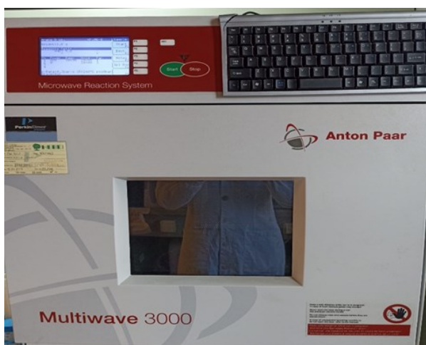
Slika 2. Mikrovalna digestivna peć (Perkin Elmer Multiwave 3000), SAD). Izvor: Lea Perić
