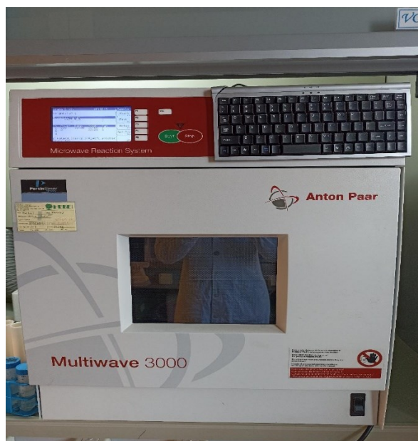
Slika 3. Digestivna peć u kojoj se razario uzorak kose (fotografija: Sara Ramljak)
