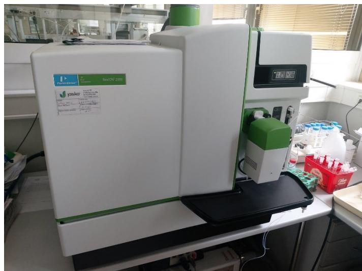
Slika 5. ICP-MS uređaj (NexION 2000 (Perkin Elmer Instruments, Waltham, MA, SAD) (vlastita fotografija)
