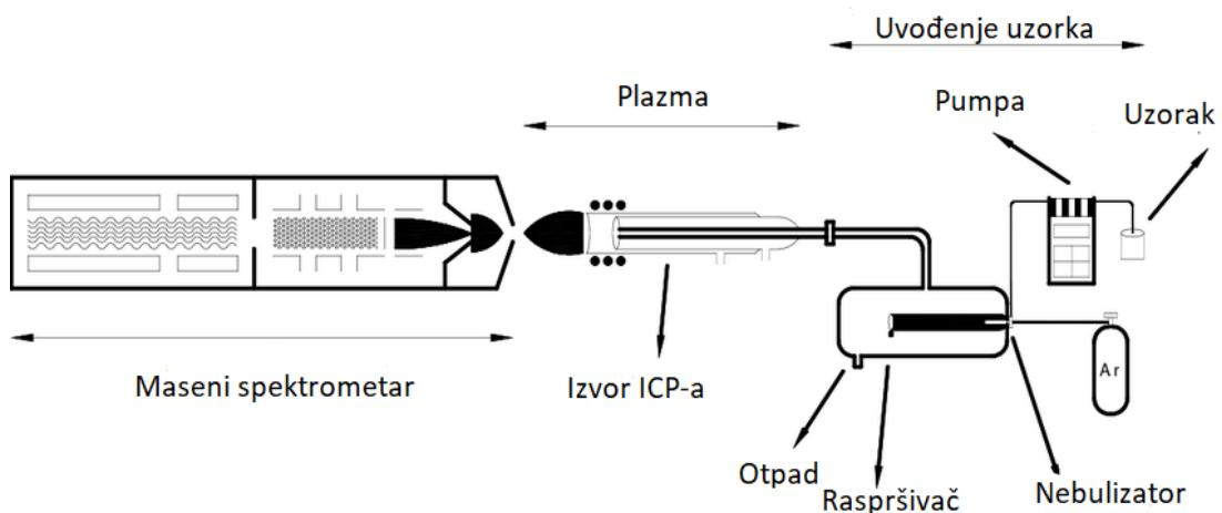
Slika 4. Prikaz rada ICP-MS instrumenta, prilagođeno prema (14).
