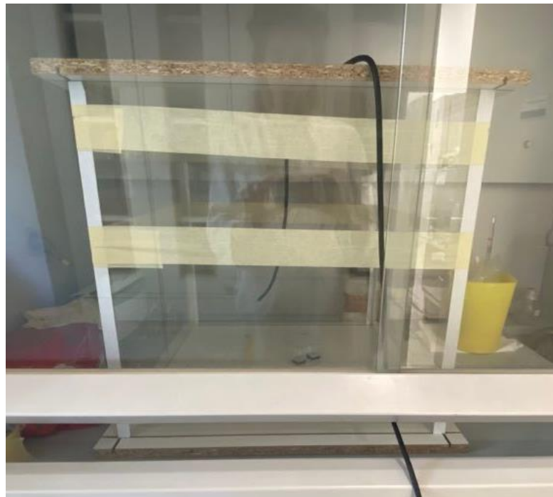
Slika 5. Ozonizator unutar kojeg su mikrotitarske pločice sa pripremljenim bakterijskim suspenzijama
