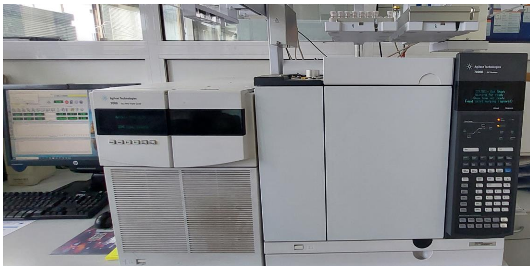
Slika 12. Prikaz instrumenta za plinsku kromatografiju sa spektrometrom masa; GC-MS-MS (Agilent 7000 Triple Quad, Sjedinjene Američke Države); izvor: vlastita fotografija
