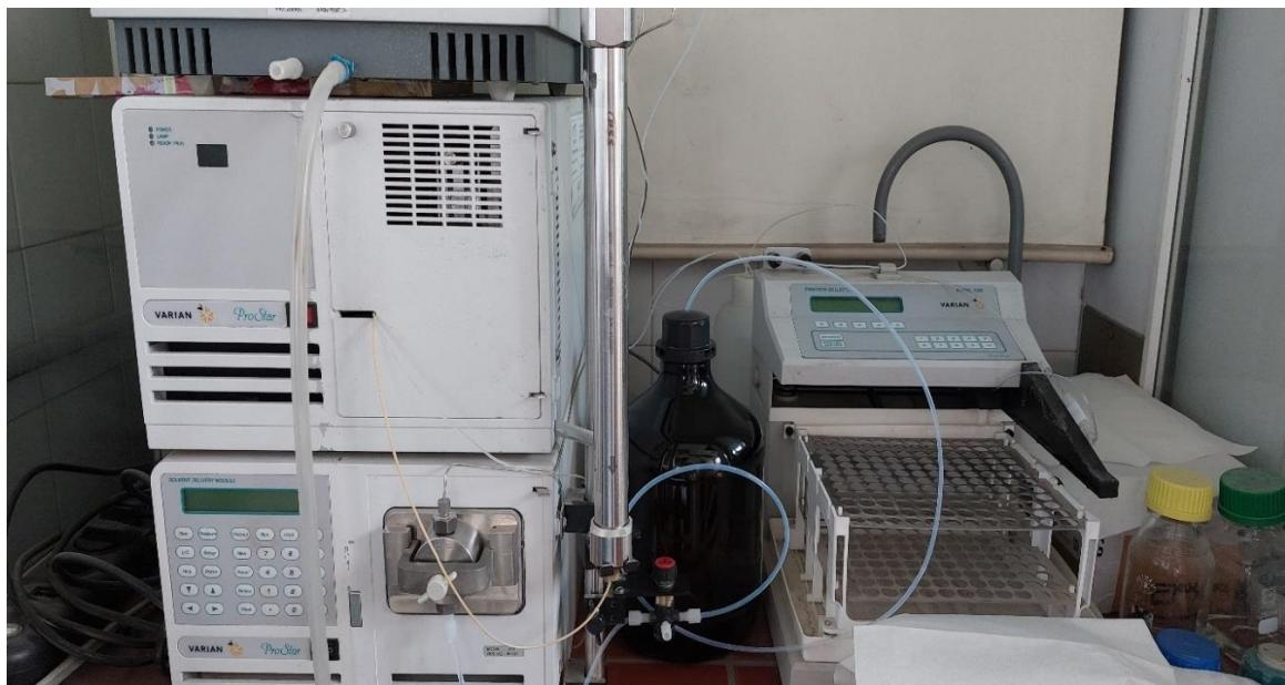
**Slika 14.** Prikaz instrumenta za gel permeacijsku tekućinsku kromatografiju; GPLC (Varian, ProStar, Ujedinjeno Kraljevstvo); izvor: vlastita fotografija
