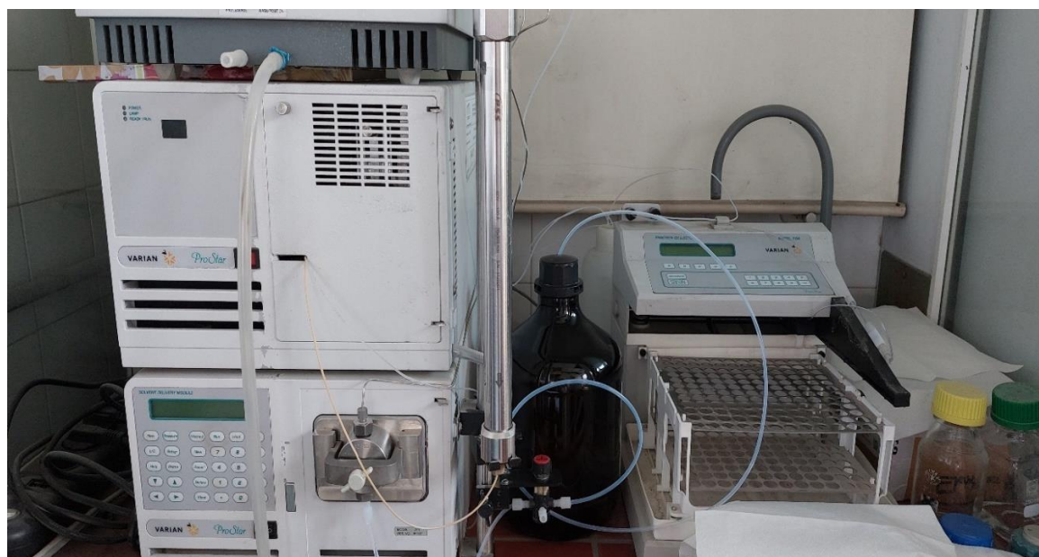
Slika 14. Prikaz instrumenta za gel permeacijsku tekućinsku kromatografiju; GPC (Varian, ProStar, Ujedinjeno Kraljevstvo); izvor: vlastita fotografija
