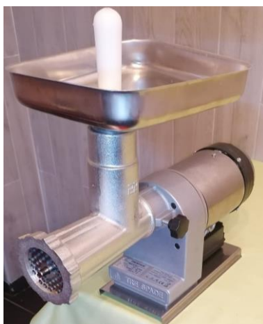
Slika 2. Automatska mašina za mljevenje mesa
