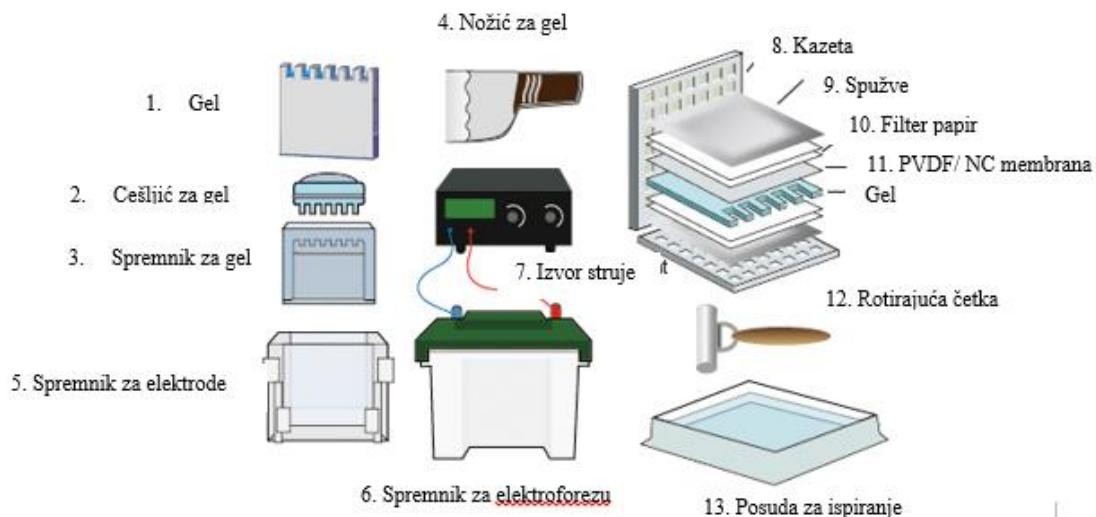
**Slika 4.** Oprema potrebna za provedbu Western blot metode
