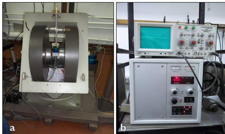
Slika 11. Komponente ESR spektrometra: a) magnetsko polje i b) kontrola mikrovalnog polja.
