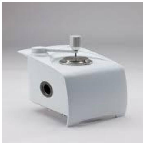
**Slika 18:** UATR oprema dodatak za FTIR.
