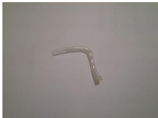
**Slika 3:** Degradirana cjevčica za slušni aparat (nakon uporabe).
