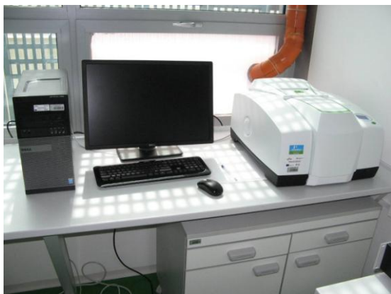
Slika 17: Perkin Elmer- Frontier FTIR Dual range (NIR+MIR) uređaj s UATR-om.
