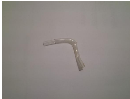
Slika 3: Degradirana cjevčica za slušni aparat (nakon uporabe).
