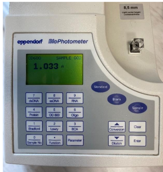
Slika 2. Očitanje optičke gustoće vode na spektrometru nakon kontaminacije sa S.aureus .
