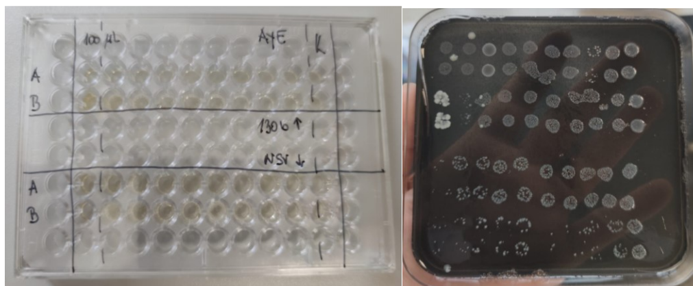
Slika 8. Mikrotitarska pločica pripremljena za određivanje MIK – a i MBK – a i hranjiva podloga nakon inkubacije
