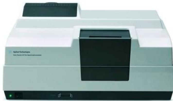
**Slika 7.** Cary 100 UV-VIS spektrofotometar (Fotografija:
