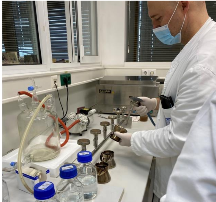
Slika 1. Postupak provođenja sterilizacije aparature pomoću plamena
