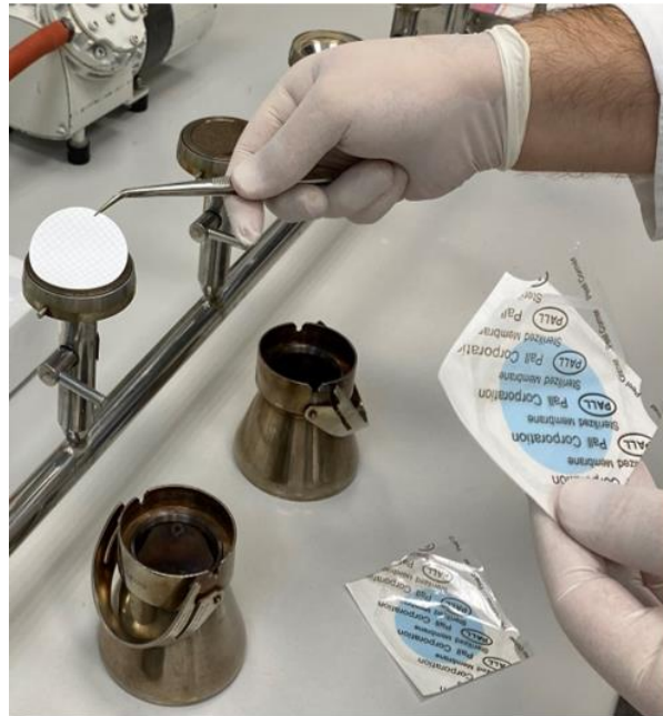
Slika 3. Postavljanje sterilnog filtra na aparaturu
