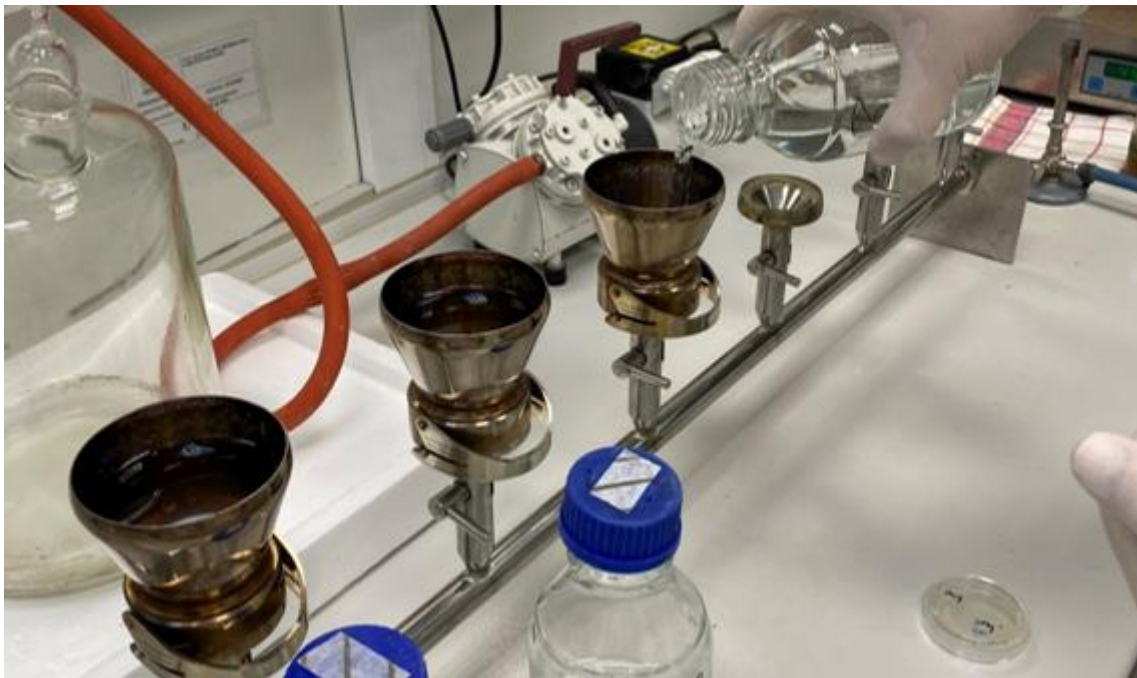
Slika 4. Filtriranje 100 mL uzorka preko sterilnog filtra
