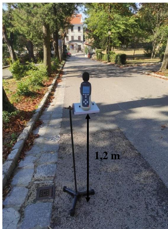
**Slika 10.** Pravilno postavljen mikrofon iznad tla za mjerjenje buke.
