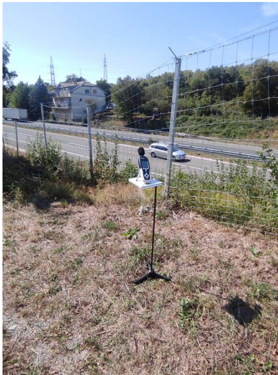
Slika 14. Pozicija bukomjera uz autocestu (lijevo), prikaz lokacije na karti (desno).
