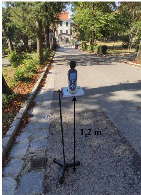
Slika 10. Pravilno postavljen mikrofon iznad tla za mjerenje buke.
