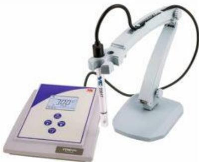
Slika 16. Konduktometar (izvor: <https://instrumentimb.rs/50003002/>)
