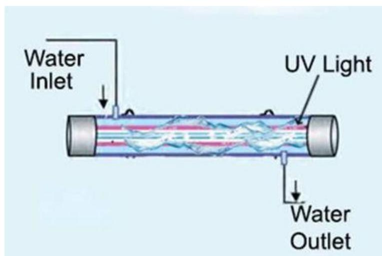
Slika 7. UV metoda (izvor: [www.waterdisinfection.gr](http://www.waterdisinfection.gr))
