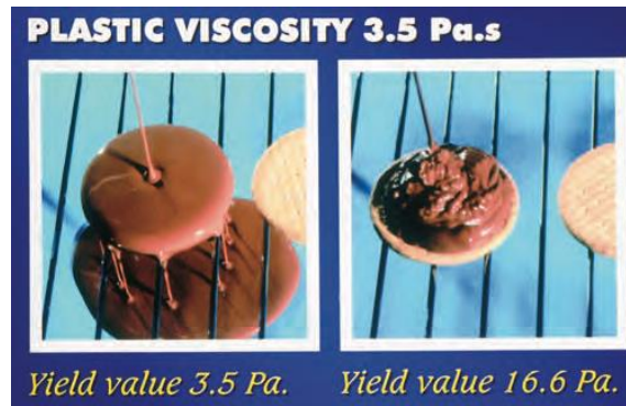
Slika 2. Prikaz dviju čokoladnih masa jednakog plastičnog viskoziteta ( PLASTIC VISCOSITY ), ali različite granične vrijednosti tečenja ( Yield value ) (26)
