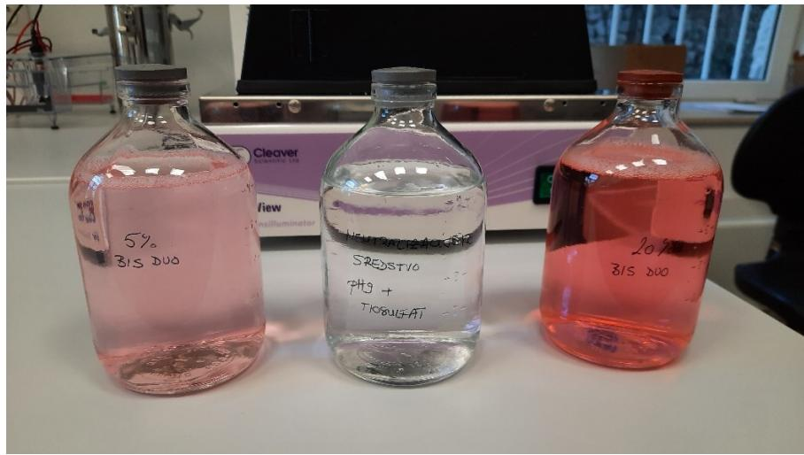
Slika 15. Korišteni dezinficijens BIS DUO Active koncentracija 5% i 20% te neutralizacijsko sredstvo pri pH 9 s tiosulfatom
