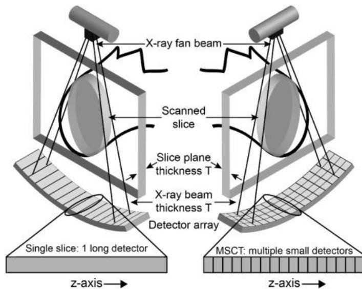
Slika 2. Lijevo se nalazi prikaz detektorskog niza u jednoslojnem CT uređaju, a desno više paralelnih detektorskih redova kako se nalaze u višeslojnem CT uređaju (19)
