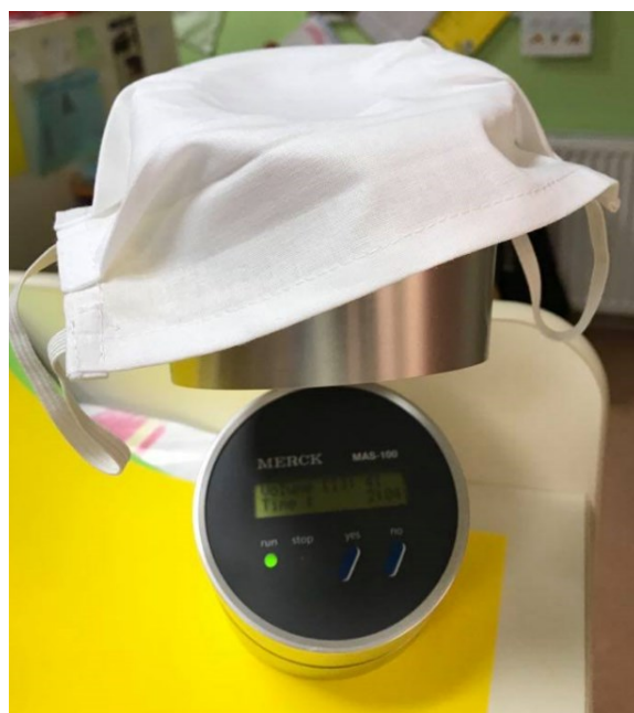
Slika 7. Uzorkovanje zraka korištenjem platnene zaštitne maske za lice MAS-100 uređajem.
