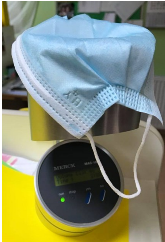
Slika 8. Uzorkovanje zraka korištenjem kirurške zaštitne maske za lice MAS-100 uređajem.
