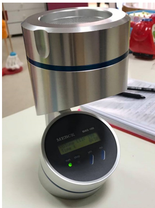
Slika 6. Uzorkovanje zraka korištenjem MAS-100 uređaja.
