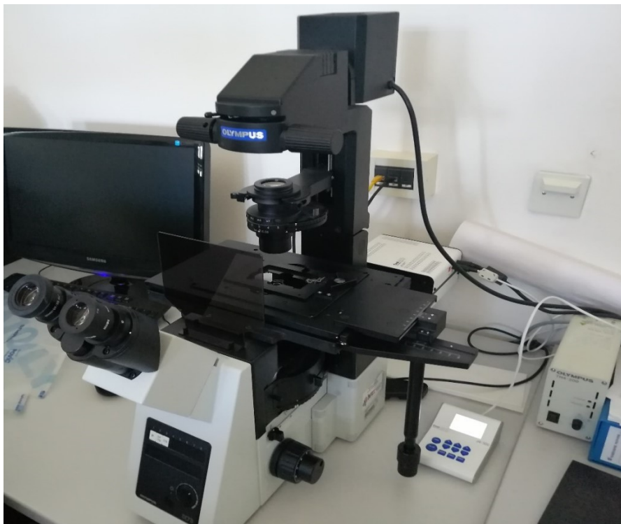
Slika 2. Olympus® IX73P1F Inverted Microscope, Japan (Fotografija: Ela Mijatović).
