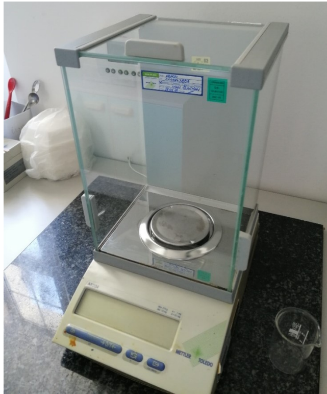
Slika 1. METTLER TOLEDO® Analitička vaga AB204, Hrvatska (Fotografija: Ela Mijatović).
