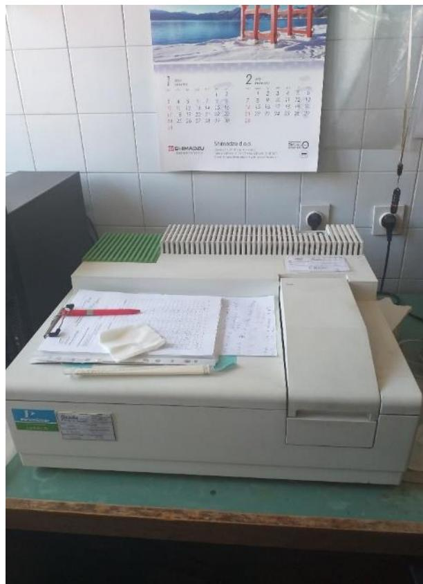
Slika 5. UV/VIS spektrofotometar Lambda 25
