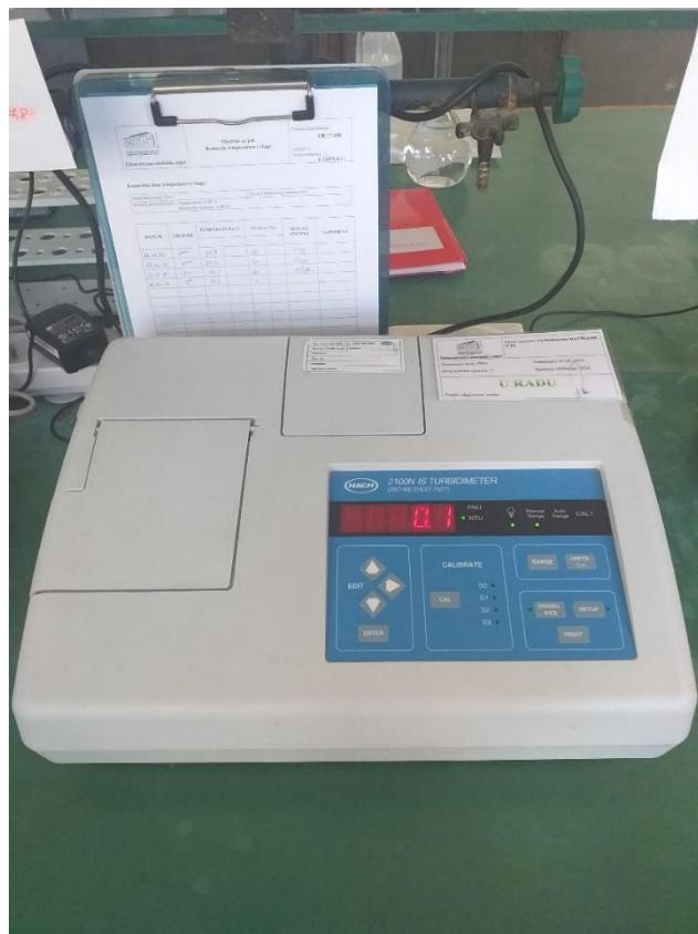
Slika 6. Turbidimetar, HACH 2100N IS
