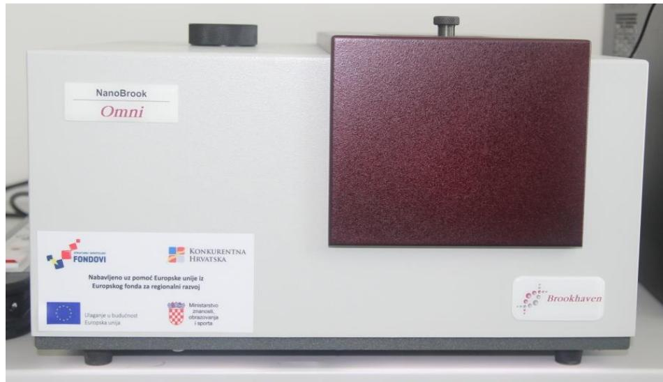
**Slika 10.** Instrument za mjerjenje dinamičkog raspršenja svjetla Brookhaven NanoBrook Omni u Laboratoriju za koloide, polielektrolite i međupovršine pri Centru za mikro i nanoznanosti i tehnologije Sveučilišta u Rijeci.
