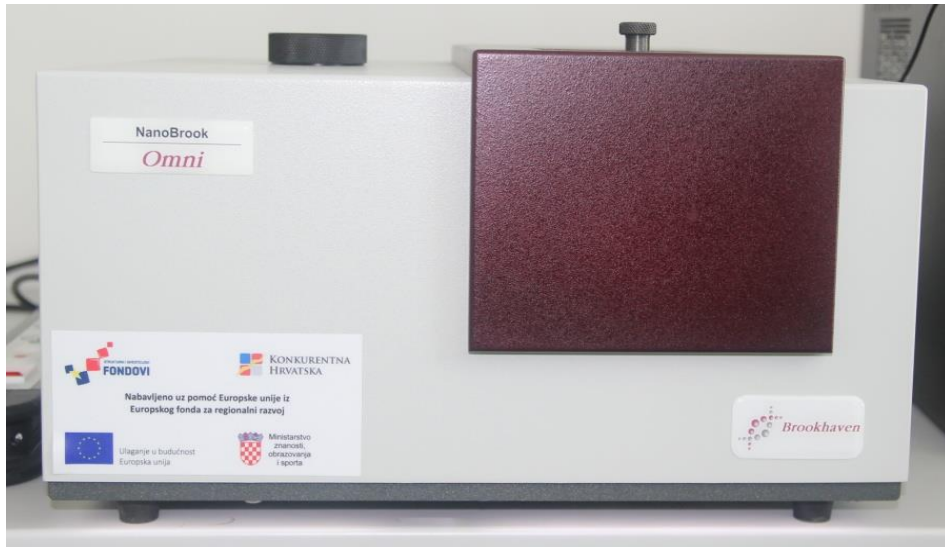
Slika 10. Instrument za mjerenje dinamičkog raspršenja svjetla Brookhaven NanoBrook Omni u Laboratoriju za koloide, polielektrolite i međupovršine pri Centru za mikro i nanoznanosti i tehnologije Sveučilišta u Rijeci.
