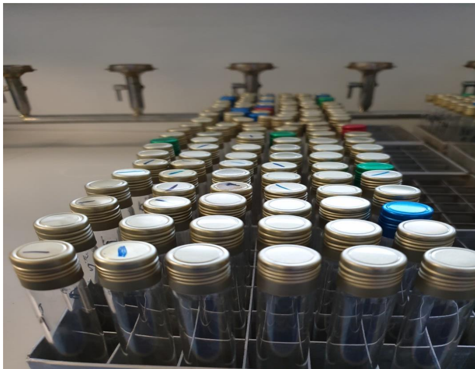
Slika 5. Staklene epruvete u kojima je određivan MIK (autorska slika)
