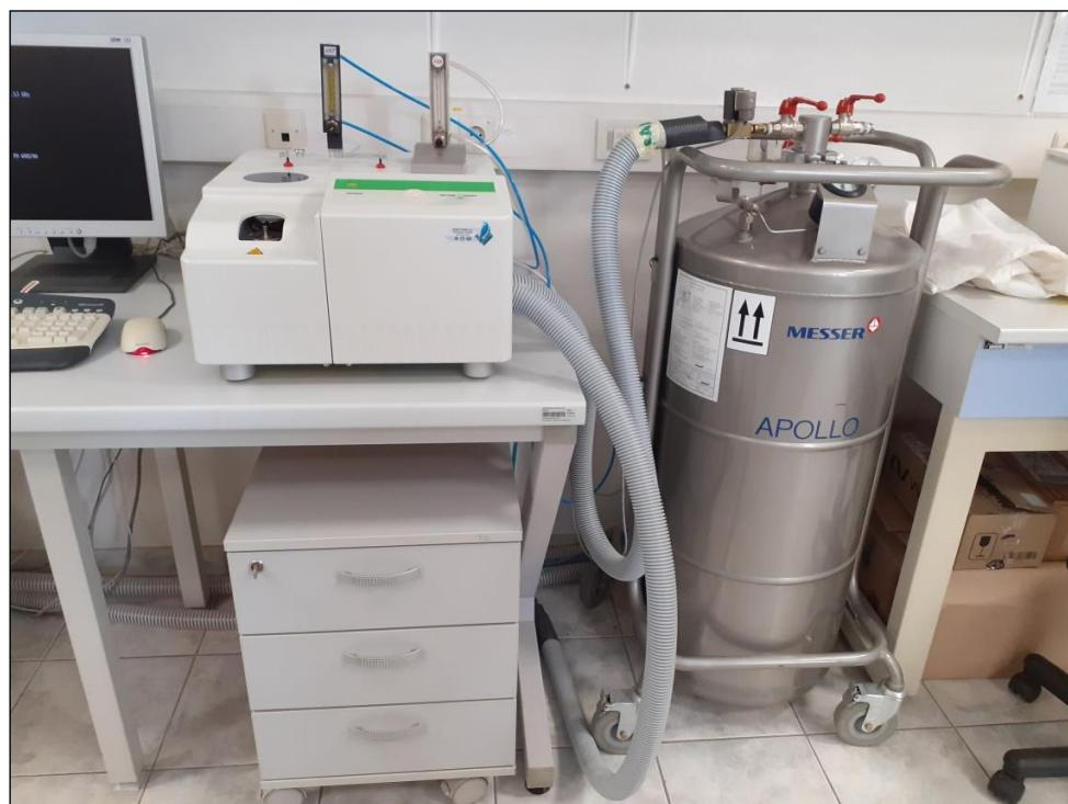
**Slika 10.** Uređaj za razlikovnu pretražnu kalorimetriju Mettler Toledo 822e s popratnom opremom.
