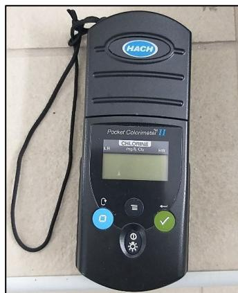
Slika 22. HACH uredaj za mjerjenje rezidualnog klora
