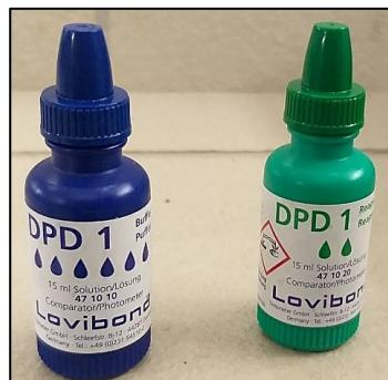
Slika 23. DPD reagens i pufer za mjerjenje rezidualnog klora
