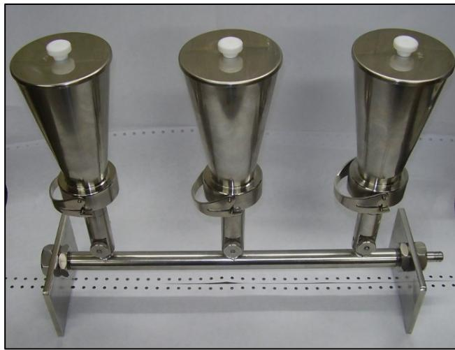
**Slika 26.** Uredaj za membransku filtraciju (izvor : Inkolab. Dostupno na : <http://inko.hr/> )
