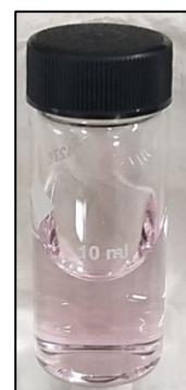
Slika 24. Kiveta za mjerjenje rezidualnog klora
