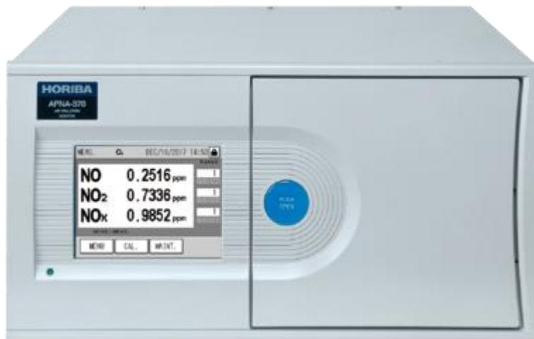
Slika 10. APNA-370 Ambient NOx Monitor, uređaj za mjerjenje vrijednosti NO<sub>x</sub>-a
