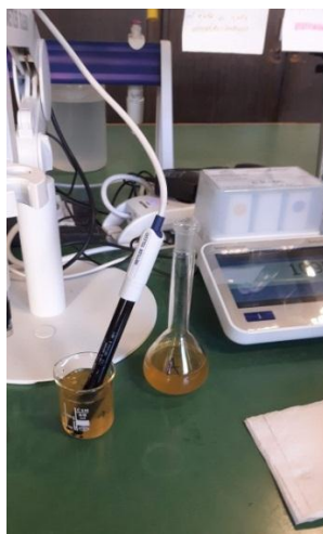
Slika 2. Mjerenje električne vodljivosti
