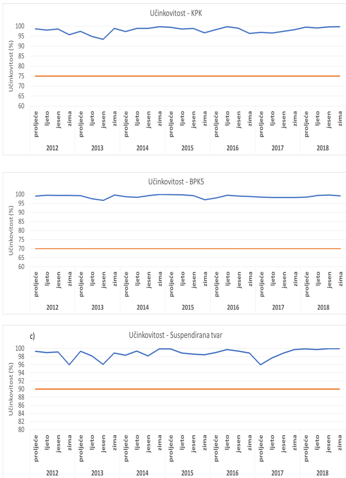
Slika 35. Efikasnost primorskog uređaja za a) kemijsku potrošnju kisika (KPK) b) biokemijsku potrošnju kisika (BPK 5 ) i c) suspendiranu tvar
