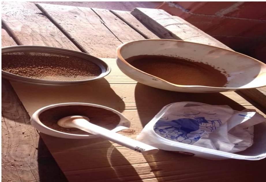
Slika 6. Proces pripreme uzoraka tla za analizu (Romano Karleuša)
