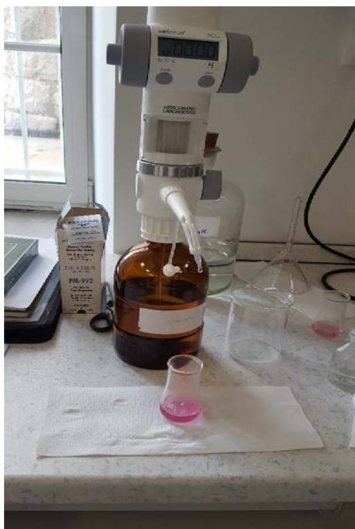
Slika 9. Automatsko titriranje suspenzije uzorka tla s NaOH
